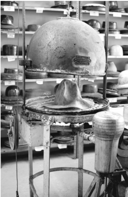
Unter einer Dampfglocke werden die feuchten Filzstumpen gedämpft, dadurch werden sie dehn- und formbar.
